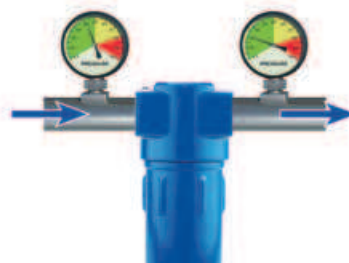
Opór ciśnieniowy, nazywany także ciśnieniem różnicowym (przed i za elementami wyposażenia)
