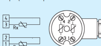
2x połączenie 2-przewodowe
